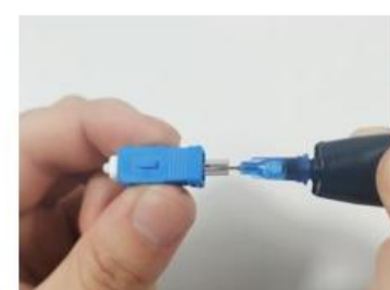
①: Pour the glue into ceramic ferrule
