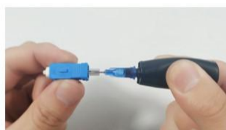
①: Pour the glue into ceramic ferrule
