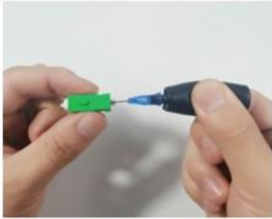
①: Pour the glue into ceramic ferrule
