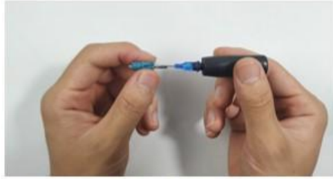
①: Pour the glue into ceramic ferrule
