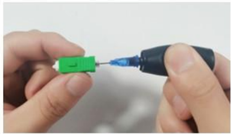
①: Pour the glue into ceramic ferrule
