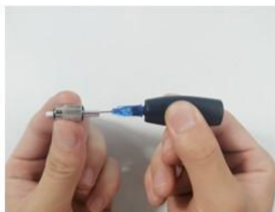
①: Pour the glue into ceramic ferrule
